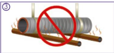
3.- No lo instale cerca de superficies calientes (calderas, tubos de vapor, calentadores, balastos, etc).
