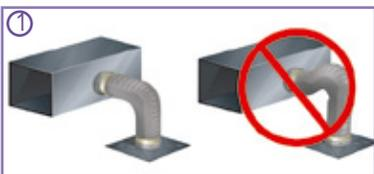
1.- Instale el ducto completamente extendido. No lo instale en su forma comprimida.
