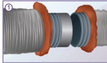
1.- Jale la cubierta metálica y el aislamiento, dejando al descubierto el núcleo. Una ambos núcleos con una manga de metal estándar de 4 pulg. (100 mm) de largo.
