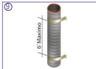
9.- Los conductos instalados verticalmente tienen que ser estabilizados por cinchos a un máximo de seis pies entre soportes a través del centro.
