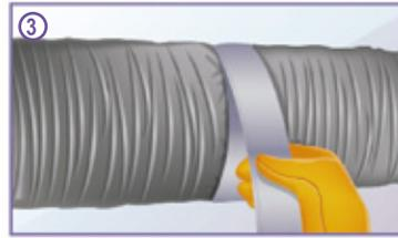
3.- Vuelva a colocar el aislamiento y la cubierta metálica. Envuelva las cubiertas juntas, con al menos dos vueltas de cinta para ducto.
