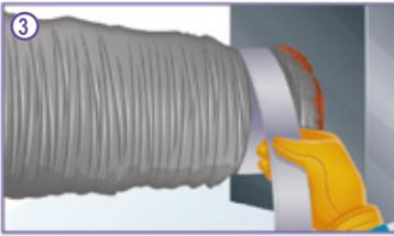
3.- Vuelva a colocar el aislamiento y la cubierta metálica. Envuelva la cubierta con al menos dos vueltas de cinta para ducto. También puede usarse una abrazadera.
