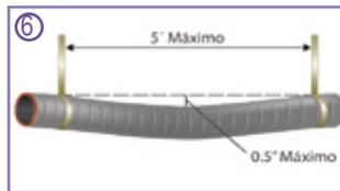
6.- El ducto flexible debe colgarse a un máximo de 5 pies (1.5 mts) entre soportes y con una pendiente máxima de 1/2 pulg. (12.5 mm) por pie lineal. La conexión a un conducto rígido se considera como un soporte.
