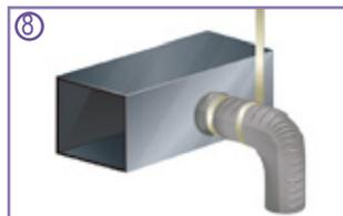
8.- Soporte el ducto entre una conexión de metal y un doblez, permitiendo al ducto extenderse derecho unas cuantas pulgadas antes de hacer el doblez.
