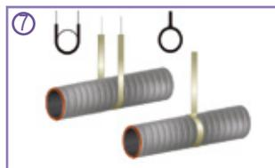
7.- El material que soporta al tubo no debe ser menos a 1.5 pulg. (38 mm) de ancho y no debe afectar el diámetro del ducto.
